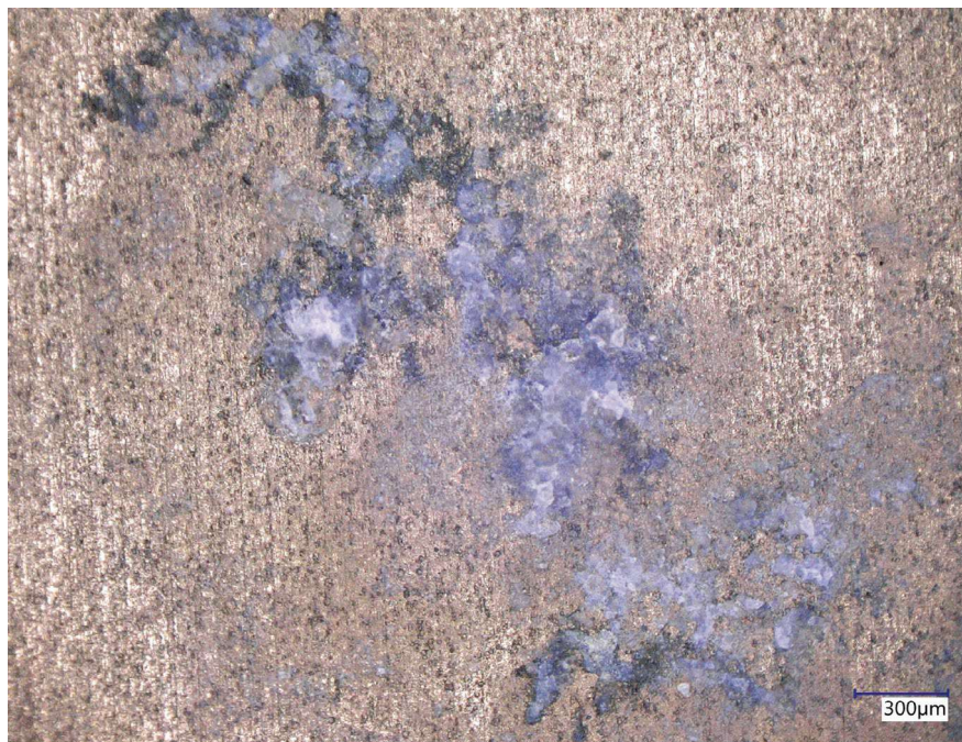
Korrosionsprodukte im Band-Eloxal-Überzug bei maritimer Beanspruchung als mikroskopische Weißrost-Darstellung.
