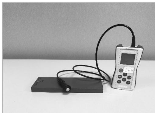
Abb. 3 - Schichtdickenmessgerät
