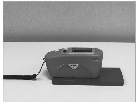
Abb. 2 - Glanzmessgerät
