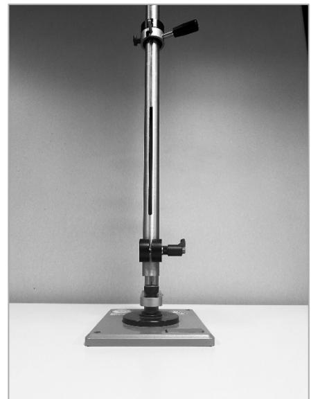
Abb. 8 - Kugelschlagprüfung
