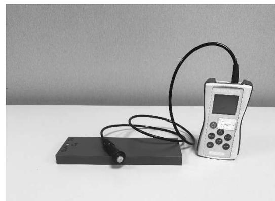
Abb. 4 - Schichtdickenmessgerät
