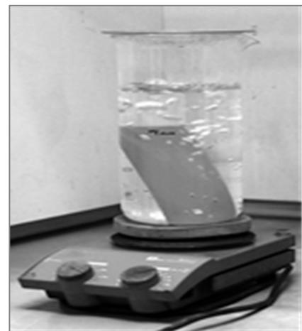
Abb. 6 - Nasshaftungstest
