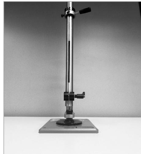
Abb. 11 - Kugelschlagtestgerät
