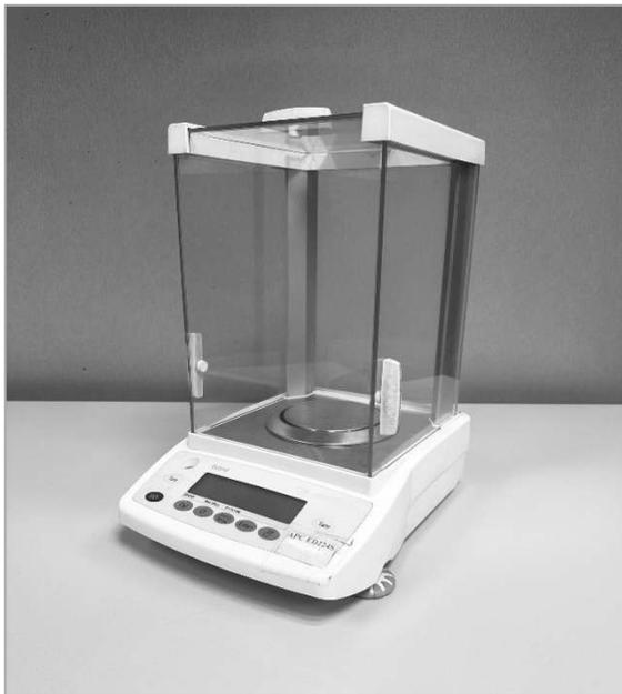
Abb. 2 - Analysenwaage
