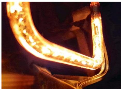
Infrarot-Strahler können genau an Konturen angepasst werden und kontaktfrei Grate wegschmelzen, ohne dabei das Produkt zu beschädigen. Foto: Heraeus
