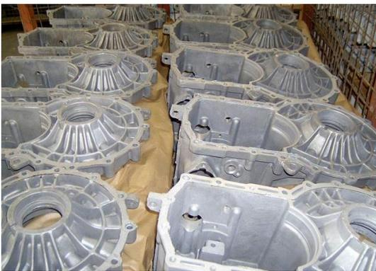
Aluguss-Getriebegehäuse nach dem Entlackungsprozess
