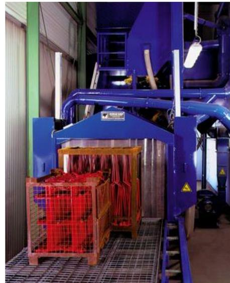
Durchlaufstrahlanlage 35 m lang
